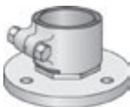
Бронза. Фланец с восемью отверстиями по окружности. Номинальное давление 16, соответствует DIN 2566. Труба обжимается встроенным хомутиком при помощи болта.
