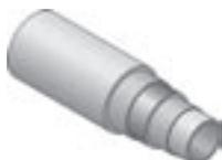
Абсолютно кислородонепроницаемая композиционная труба, пятислойная (полиэтилен PE-RT – клей – сваренная внахлест алюминиевая труба – клей – полиэтилен PE-RT), для водоснабжения, радиаторного и напольного отопления.
