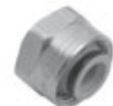
Гайка из покрытой латуни, штуцер из PPSU (полифенилсульфон), кольцо из полиамида. Для соединения с резьбовыми фитингами МЛС и коллекторами для водоснабжения и отопления.
