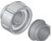
Состоит из гайки  $3/4''$  ВР из покрытой латуни, зажимного кольца из латуни и эластичного уплотнения с «евро-конусом» из EPDM. Для соединения медной трубы 15 x 1 мм угольников, тройников с вентилями, клапанами, радиаторами или адаптерами для радиаторных соединений с «евро-конусом» НР  $3/4''$ . Гайка затягивается до упора гаечным ключом 30.
