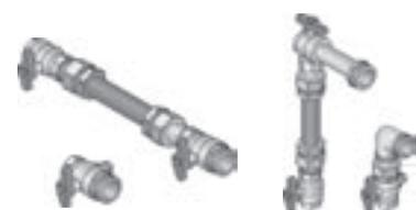
Комплект для подключения счетчиков тепла, совместим со всем распределителями Profi, два типа: горизонтальный и вертикальный. Для всех стандартных моделей счетчиков. Состоит из самоуплотняющихся соединителей – шаровой вентиль 3/4" питающего распределителя с прямым подключением к датчику диам. 5/5.2 мм, НР 10x1". Подключение к обратному коллектору снабжено 2 шаровыми вентилями 3/4", переходника с 1" на 3/4" для счетчика на 1" длиной 130 мм и ниппеля 3/4" для счетчика длиной 110 мм.
