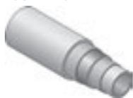
Абсолютно кислородонепроницаемая композиционная труба, пятислойная (полиэтилен PE-RT – клей – сваренная внахлест алюминиевая труба – клей – полиэтилен PE-RT), для водоснабжения и радиаторного отопления.
