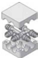
Трехсторонний переходной фитинг для радиаторного соединения. Со встроенными пресс-гильзами. Покрытая латунь. Комплектуется изоляционной коробкой из EPP (пенополипропилена), толщина изоляции в нижней части 13 мм (уровень изоляции 50 % в соответствии стандарту EnEV\*), теплопроводность 035.
