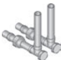
Хромированная медь. Для радиаторных соединений с плинтусной разводкой. С медной трубой 15 x 1 мм, шаровыми вентилями и фитингом для соединительных узлов SL. С помощью резьбового адаптера для зажима  $\frac{3}{4}$ " ВР x 15 Cu (артикул 77 00 34) возможно подключение хромированной медной трубы 15 x 1 мм к крану, радиатору или адаптеру для радиаторных соединений с «евроконусом»  $\frac{3}{4}$ ".
