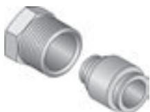
Покрытая латунь. С нажимным винтом (НР), зажимным кольцом и вставной гильзой с уплотнительным кольцом серого цвета. Для соединения с радиаторными клапанами Heimeier с ВР.
