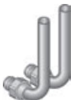
Хромированная медь. Для радиаторных соединений с плинтусной разводкой. С медной трубой 15 x 1 мм и фитингом для соединительных узлов SL. С помощью резьбового адаптера для зажима  $\frac{3}{4}$ " ВР x 15 Cu (артикул 770034) возможно подключение хромированной медной трубы 15 x 1 мм к крану, радиатору или адаптеру для радиаторных соединений с «евроконусом»  $\frac{3}{4}$ ".
