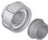
Состоит из гайки  $\frac{3}{4}$ " ВР из покрытой латуни, зажимного кольца из латуни и эластичного уплотнения с «евроконусом» из EPDM. Для соединения медной трубы 15 x 1 мм пресс-угольников, тройников и пресс-соединений SL из программы Uponor MLC с вентилями, клапанами, радиаторами или адаптерами для радиаторных соединений с «евро-конусом» НР  $\frac{3}{4}$ ". Гайка затягивается до упора гаечным ключом 30.
