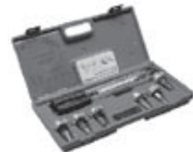
Полный набор в пластиковой коробке, тюбик смазки (коллоидная графитовая смазка), инструкция по установке и расширительные головки (см. описание).
