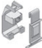
Полиамид. Состоит из запорной линейки и зажима. Цвет черный, для труб с внешним диаметром до 22 мм. Дает возможность открыть плинтус даже после монтажа. Регулируется по высоте примерно до 8 мм.
