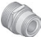
Покрытая латунь. С самогерметизацией. Для радиаторных соединений с ВР  $\frac{1}{2}$ "; «евроконус»  $\frac{3}{4}$ " для соединения медной трубы 15 x 1 мм с резьбовым адаптером, трубы Uponor MLC с резьбовым адаптером MLC, а также трубы Uponor eval-PEX с резьбовым адаптером PEX.
