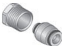
Покрытая латунь. С нажимным винтом (НР), зажимным кольцом и вставной гильзой с уплотнительным кольцом черного цвета. Для соединения с радиаторными клапанами Oventrop с ВР.
