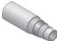
Абсолютно кислородонепроницаемая композиционная труба, пятислойная (полиэтилен PE-RT – клей – сваренная внахлест алюминиевая труба – клей – полиэтилен PE-RT), для водоснабжения и радиаторного отопления, в прямых 5-метровых отрезках.
